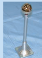
PLAM : プラズマ計測装置
