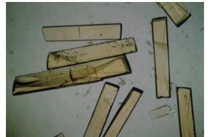
地上で作った結晶はひび割れている
