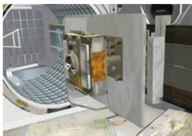
2 簡易曝露実験装置(ExHAM)に搭載サンプルを取り付け、「きぼう」のエアロックから船外に搬出する。
