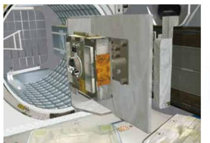
2 簡易曝露実験装置(ExHAM)に搭載サンプルを取り付け、「きぼう」のエアロックから船外に搬出する。
