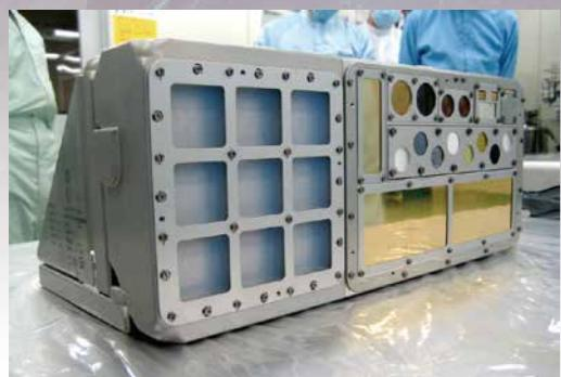
「きぼう」の宇宙環境計測ミッション装置(SEDA-AP)に搭載された「微粒子捕獲実験(MPAC)」と「材料曝露実験(SEED)」
