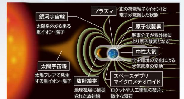
ISSは、地球の大気が微量に残る高度約400kmの軌道を、約90分で地球を一周しています。ISSを取り巻く環境は、微小重力で高真空、90分ごとに移り変わる昼と夜によって-100℃以下から+100℃以上もの温度変化が繰り返されています。高エネルギーの宇宙放射線や紫外線が降り注ぎ、太陽フレアの影響を受けて強度が変化しています。スペースデブリや宇宙塵などが飛び交い、宇宙機などの材料を浸食する原子状酸素 (酸素分子が太陽光の強い紫外線を受けて分解されたもの) が存在する、厳しい環境です。
