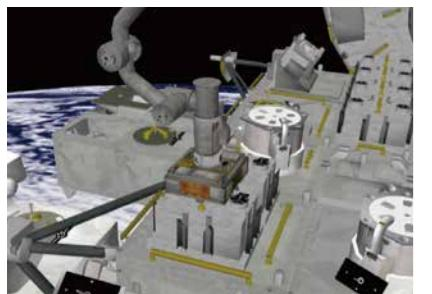
3 「きぼう」のロボットアームを地上から操作し、「きぼう」の船外部分にある手すりに取り付ける。
