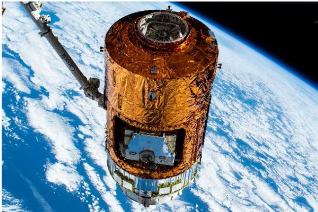
ISS離脱直前のHTV8。HTV7の曝露パレットを搭載している。
