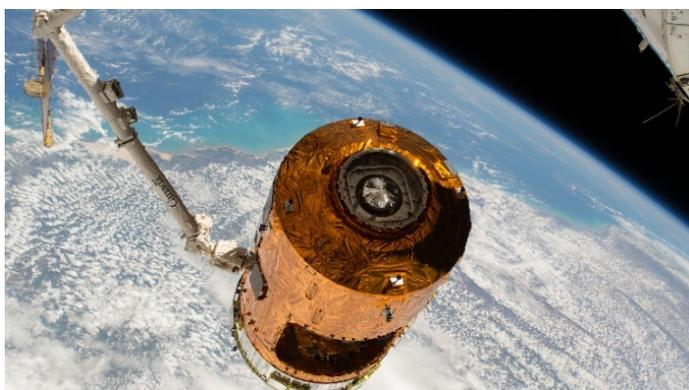
ISS離脱直前のHTV7。与圧ハッチの部分に小型回収カプセルを搭載する一方、非与圧部には曝露パレットを搭載していない。
