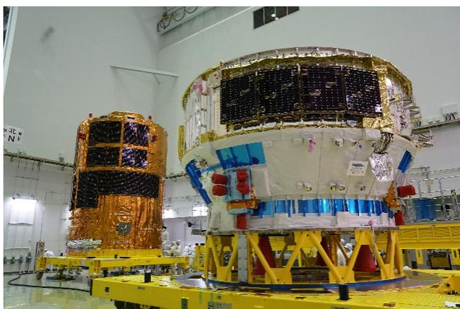
HTV6の電気モジュール・推進モジュール(右手前)と補給キャリア
