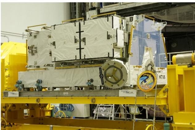
曝露パレットに取り付けられたISSバッテリー
