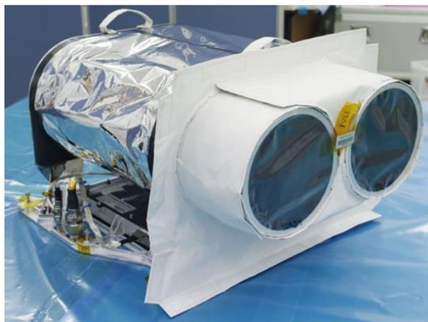
図 4-9 超小型衛星搭載用地球観測カメラ (iSIM) ©JAXA
