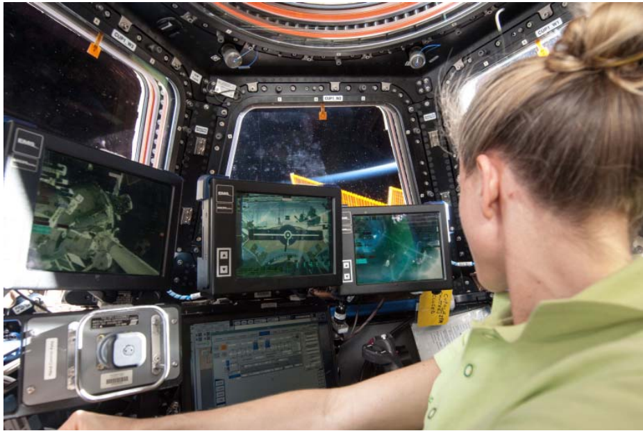
「こうのとりのとり」を把持する際に使われるキューポラのロボットアーム操作卓(4号機到着前の軌道上訓練) (NASA 提供)
