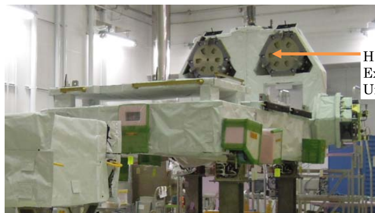
図 A1.3-1(2/2) 曝露パレット (5号機用の EP) (JAXA) (5号機では、「きぼう」の曝露ペイロードを回収・廃棄するための固定機構としてHEFUを初装備した)
