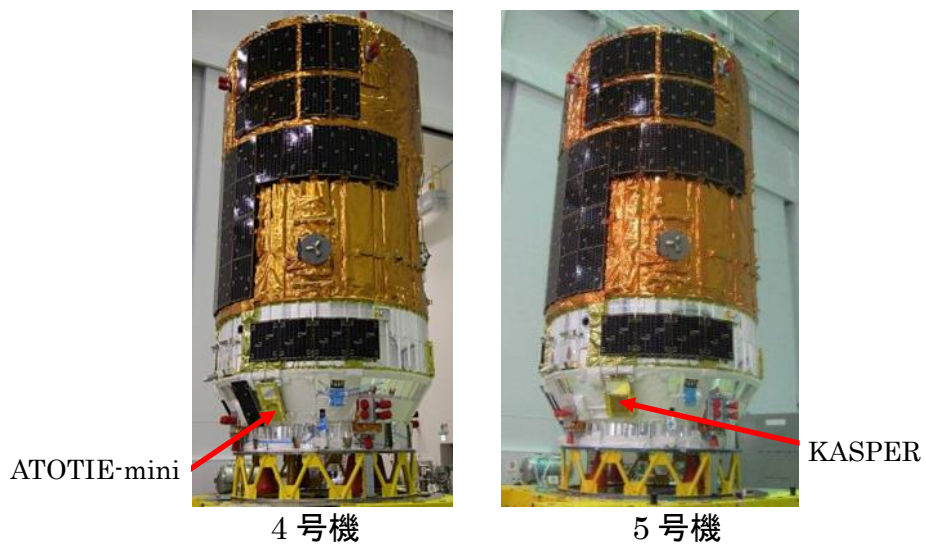
図 6.2-3 参考: 4号機の ATOTIE-mini と 5号機の KASPER の搭載写真(JAXA) ATOTIE-mini (Advanced Technology On-orbit Test Instrument for space Environment - mini) KASPER (Kounotori Advanced Space Environment Research equipment module) (「こうのとりの6号機」に搭載される帯電電位モニタ LP-POM は、KITE 実験の一部ですが、ATOTIE-mini と KASPER の設計をベースに開発した機器で、帯電電位計測の後継実験でもあります。)
