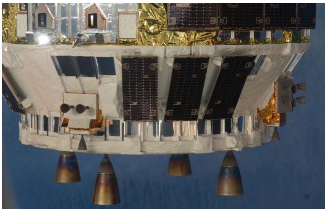
図 A1.5-3 軌道上で撮影された推進モジュール(1号機)(JAXA) (写真下部に見える4基のノズルがメインエンジン)
