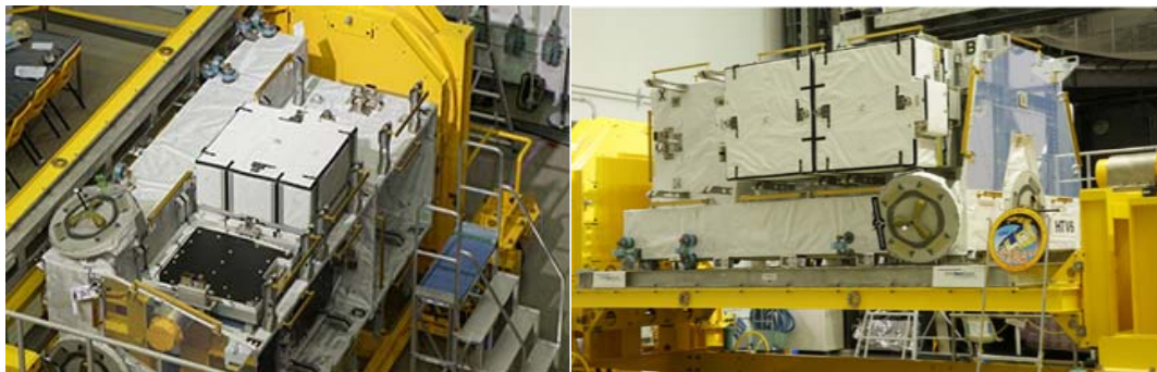
図 2-4（左）ISS用バッテリーが1台搭載された状態の曝露パレット （右）ISS用バッテリーが6台搭載された状態の曝露パレット
