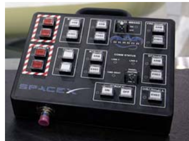
図 A1.6-4 Space X 社のドラゴン用の搭乗員用コマンドパネル (CCP)
