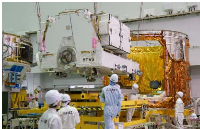
図 A1.2-2 曝露パレットの積み込み作業(6号機)(JAXA)
