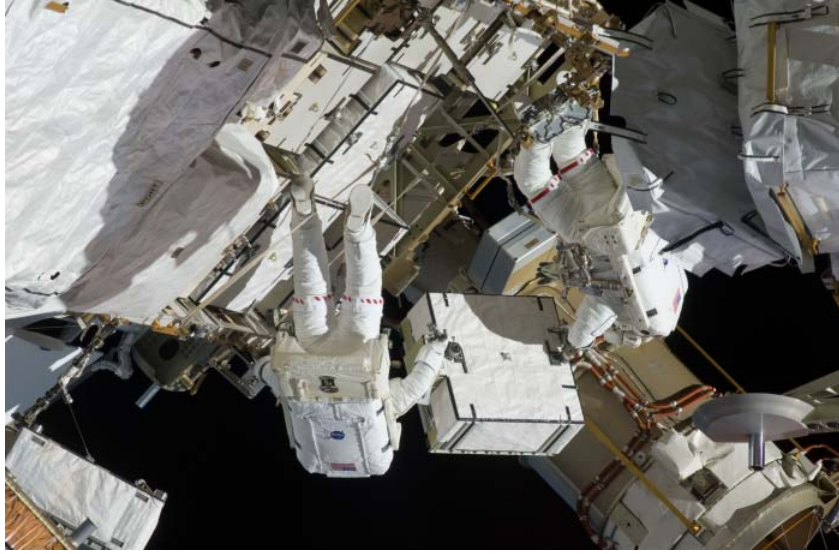
図 5.2-8 STS-127 ミッション時に行われた船外活動によるバッテリー交換作業の様子 (NASA) https://spaceflight systems.grc.nasa.gov/sopo/ihho/iss-technology-demonstration/sustaining-engineering-of-eps-hardware/s127e008452/
