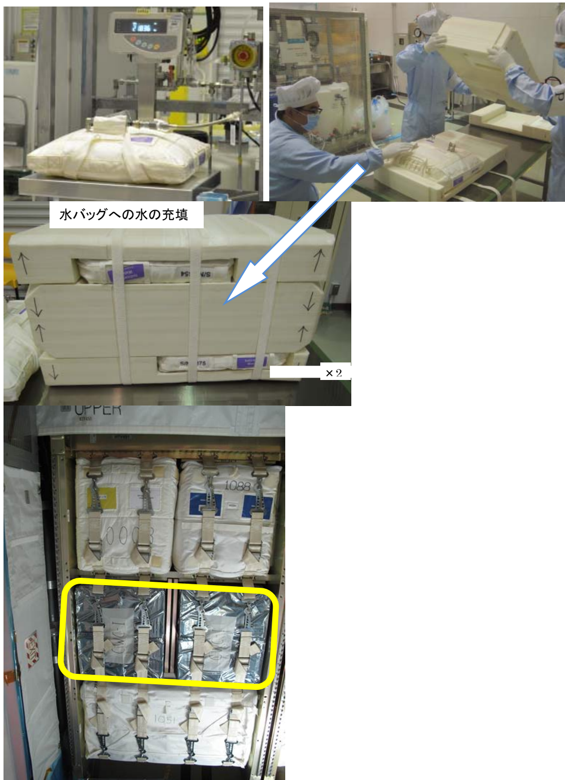
図 A2-2 飲料水を充填した水バッグ(CWC-1)と梱包材(右下:5号機、残りは6号機)(JAXA) (左下の写真で紫色のラベルがつけられた袋が水バッグで、周りは梱包材です)
