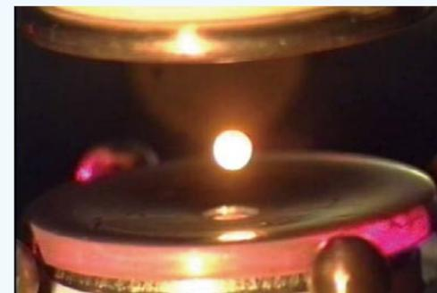
地上の静電浮遊炉で高温の試料が浮遊している様子。宇宙では、より帯電しにくい試料での成果が期待されている。
