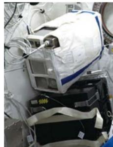
「きぼう」搭載用ポータブル冷凍・冷蔵庫 (FROST, FROST2)
