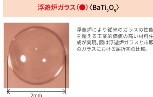
浮遊炉により従来のガラスの性能を超える工業的価値の高い材料生成が実現。図は浮遊炉ガラスと市販のガラスにおける屈折率の比較。
