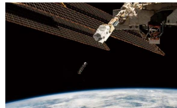
「きぼう」の小型衛星放出機構(J-SSOD)から放出された超小型衛星
