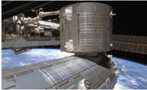
▲STS-124 (1 J) ミッションで国際宇宙ステーションに取り付けられた船内実験室と船内保管室 The PM and ELM Pressurized Section attached to the ISS during the STS-124 (1J) mission
