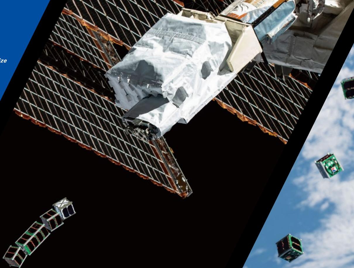
**JEM搭載小型衛星放出機構**
