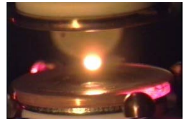
地上静電浮遊炉での浮遊と加熱
