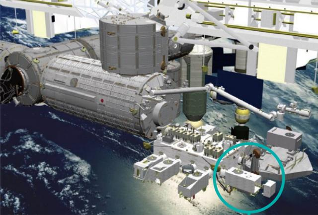
SEDA-APは、MAXI(全天X線監視装置)、衛星間通信システムとともに船外パレットに搭載され、スペースシャトルで国際宇宙ステーション(ISS)に運ばれます。「きぼう」日本実験棟の船外実験プラットフォームに取り付けられた後、中性子モニタとプラズマ計測装置のセンサ部を搭載した伸展マストを1m以上伸展させ、観測実験を開始します。SEDA-APは、宇宙環境計測機器部と曝露部搭載用共通バス機器部からなります。
