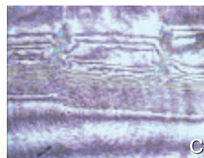
図6 振幅変調顕微鏡(a)とマツハツエンダー型干渉顕微鏡(b)(c)で見た結晶の成長の様子
