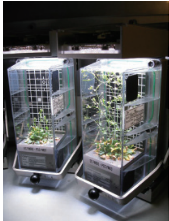
図3 地上予備実験として宇宙実験用の培養装置(Plant Cultivation Chamber)を用いて生育中のシロイヌナズナ(ノルウェーのESA実験室)
