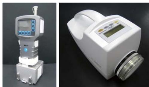
図4 微粒子カウンタ(左)とエアサンプラ(右)いずれも、市販品をベースとして宇宙搭載用に電源などを改良しています。
