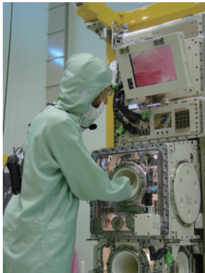
図2 「きぼう」にあるクリーンベンチ顕微鏡を内蔵して培養した細胞などを観察できる。装置上部のディスプレイに顕微鏡の画像が表示される。
