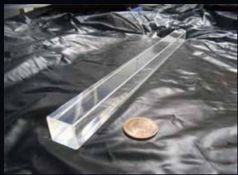
図3: タングステン酸鉛結晶シンチレータ(PWO) Figure 3: Lead tungstate crystal scintillator (PWO)
