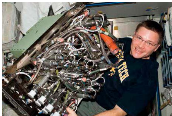
酸素生成システム（OGS）ラックに取り付ける直前のサバティエ・アッセンブリと NASA の第 25 次長期滞在チームの司令官、ダグラス・ウィーロック宇宙飛行士
