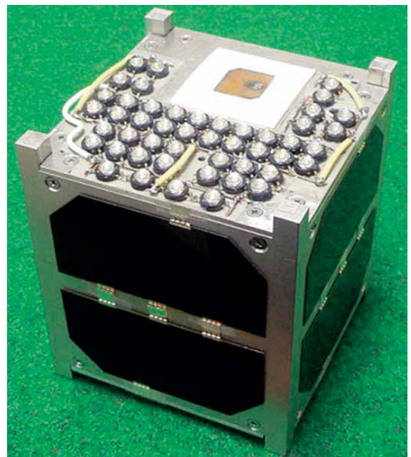
JEMRMS により軌道に放出された小型衛星の一つである FITSAT
