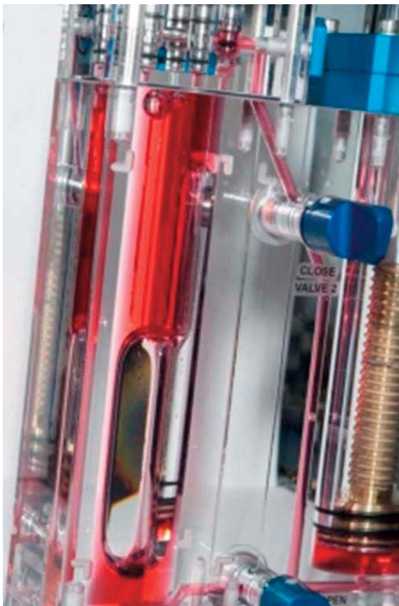
ISS での CFE-2ICF の実験で 3 つの容器がセットされた様子。これは容器内で液体がどのようなふるまいをするかを調べるもの。
