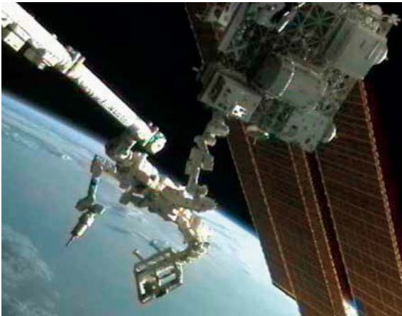
RRM（中央、プラットフォーム上）で、ISSのカナダアーム2とカナダの「デクスター」ロボット（右）を使用して衛星サービスタスクを実証します。
