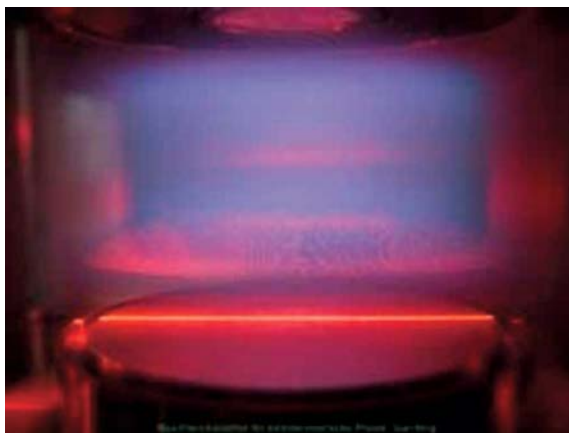
実験中のクーロン結晶を横から写したもの。高周波電極（底部）上のアルゴンプラズマに浮遊するちり粒子。写真の水平電場は2cm
