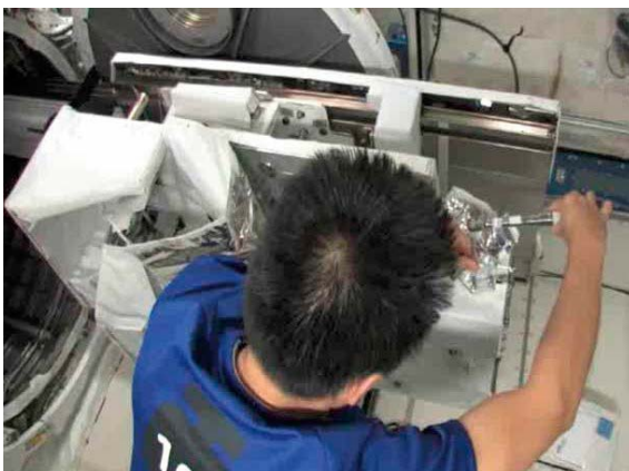
ISS の搭乗員が、衛星を JEM エアロック・テーブルに取り付ける
