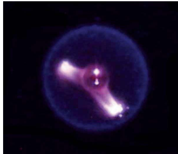
ISSでの消火実験検査中の、燃焼するヘプタン
