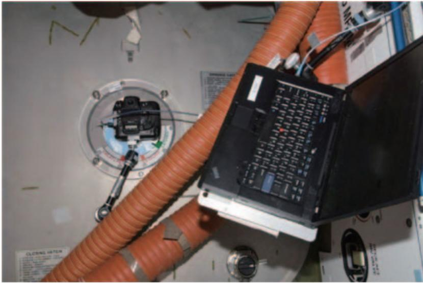
2011年7月のセッション中の第2結合部地球側ハッチの窓に金具で取り付けられたアースカムカメラ（出典：NASA）
