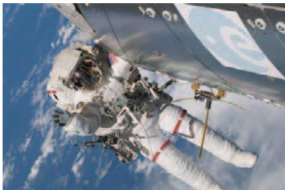
2009 年 11 月 21 日にアトランティス号で二回目の船外活動を行うランドルフ・プレスニク宇宙飛行士と、海上船舶の超短波信号の追跡実験に使用するためにコロンバス実験棟に取り付けられて展開された AIS アンテナ（出典：NASA）
