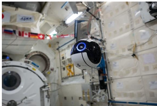
位置・姿勢推定技術を実証中の船内浮遊移動型カメラロボット“Int-Ball”
