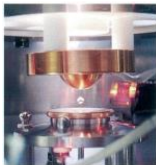
静電浮遊炉（地上実験）の様子。電極の間に電圧をかけ発生した静電気力を用い、帯電した試料を浮かべる
