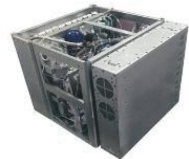
次世代水再生システムでは現在のものの4/1の小型化を進める。図は実証モデル。
