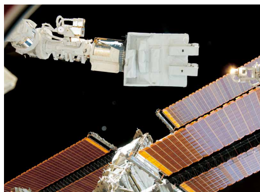
「きぼう」ロボットアームで衛星放出ポイントまで移動
