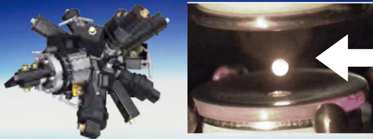
図3：静電浮遊炉と微小重力環境で浮遊中の試料
