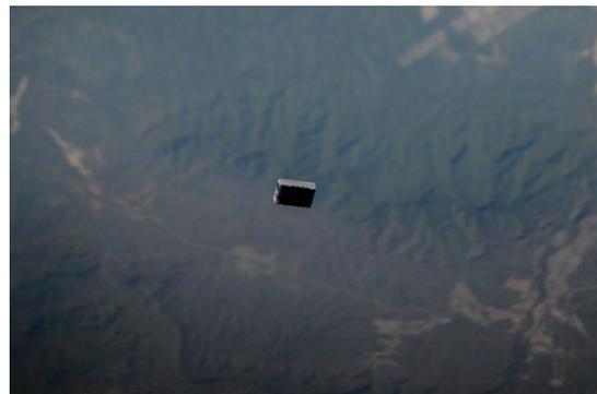
図22. 国際宇宙ステーション (ISS) からの展開後のアステリア衛星の様子。天体物理学の研究を可能にするアークセカンド宇宙望遠鏡 (Arcsecond Space Telescope Enabling Research in Astrophysics、ASTERIA) は、太陽系外の惑星の検出など、天文学観測のための新技術を試験するために国際宇宙ステーション (ISS) から配備された6ユニット (6U) のCubeSatである (ISS053E470644)。
