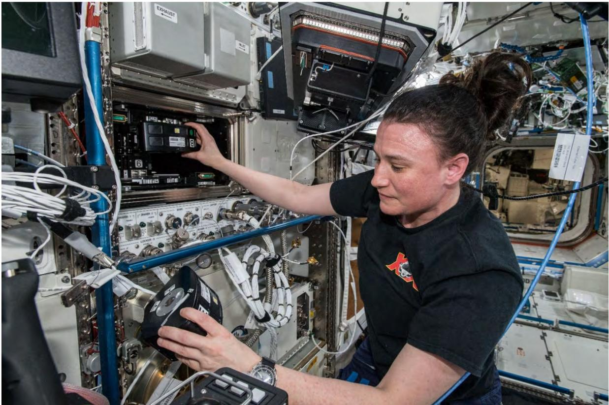
NASA の宇宙飛行士 Serena Auñón-Chancellor が、多目的可変G プラットフォーム (Multi-use Variable-g Platform、MVP) 実験装置へセメント固化の微小重力研究 (Microgravity Investigation of Cement Solidification、MICS) モジュールを挿入する作業を行っている (ISS057E106261)。
