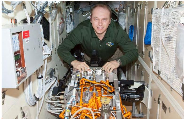
図18. ロシアの宇宙飛行士 Oleg Kotov (オレグ・コトフ) (第38次隊長)が、国際宇宙ステーションのラスベット小型研究モジュール1(MRM1)にカプリア2実験のための粒子冷却器/発生器モジュールを設置している (ISS038E029764)。
