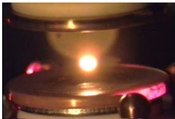
図1 地上静電浮遊炉での浮遊と加熱
