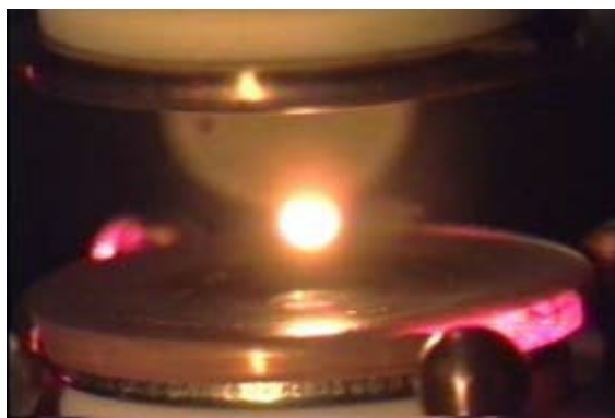
図1 地上静電浮遊炉での浮遊と加熱
