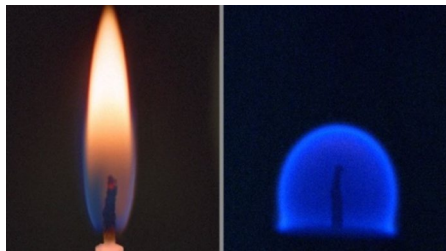
(a) 通常重力 (b) 微小重力 異なる重力環境におけるろうそく火炎 Image by NASA
