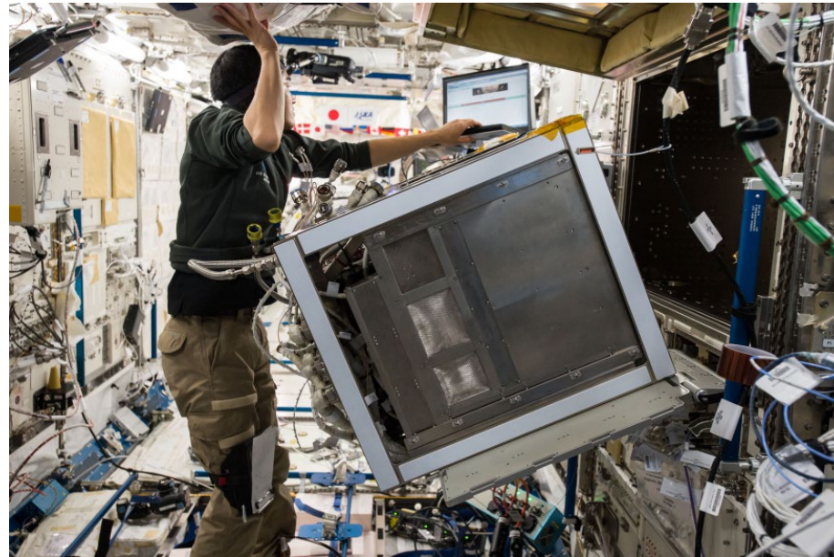
参考：多目的実験ラック2（MSPR-2）から静電浮遊炉（ELF）の取出し作業を行う大西宇宙飛行士
