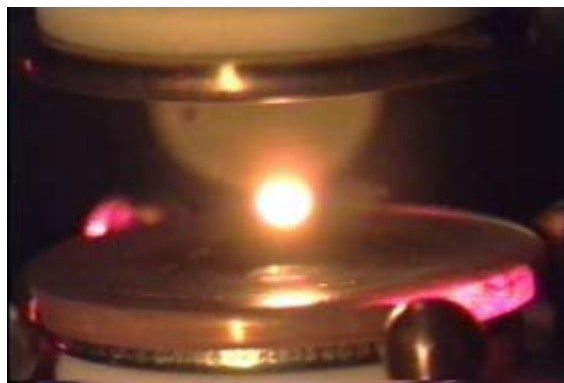
図1 地上静電浮遊炉での浮遊と加熱
