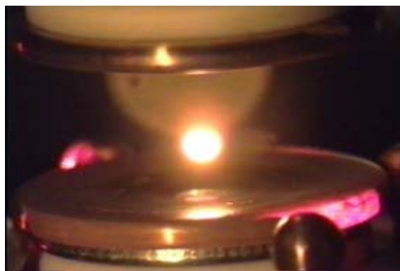
図1 地上静電浮遊炉での浮遊と加熱
