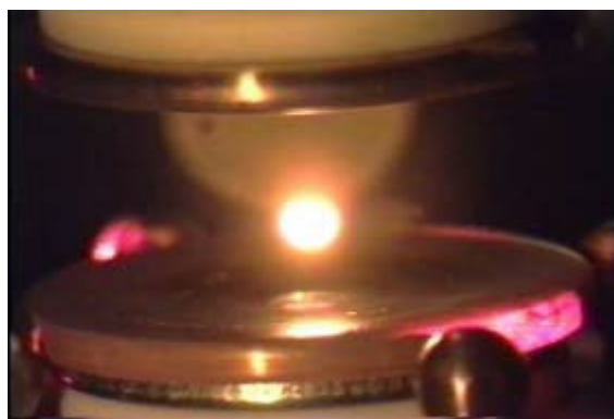
図 1 地上静電浮遊炉での浮遊と加熱
