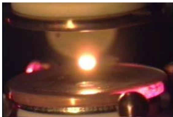
図1 地上静電浮遊炉での浮遊と加熱
