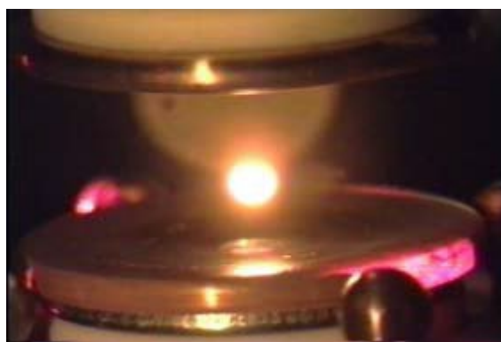
図1 地上静電浮遊炉での浮遊と加熱
